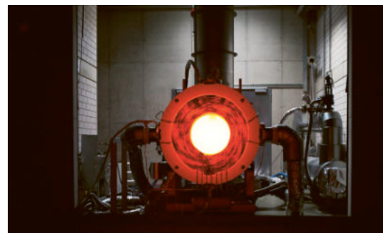
Sonnenlichtempfänger, Aufbau vor Synlight (Foto: Synhelion)
